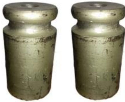
Gambar 5. Anak timbangan sebagai beban (masing-masing dengan berat 1 kg)
